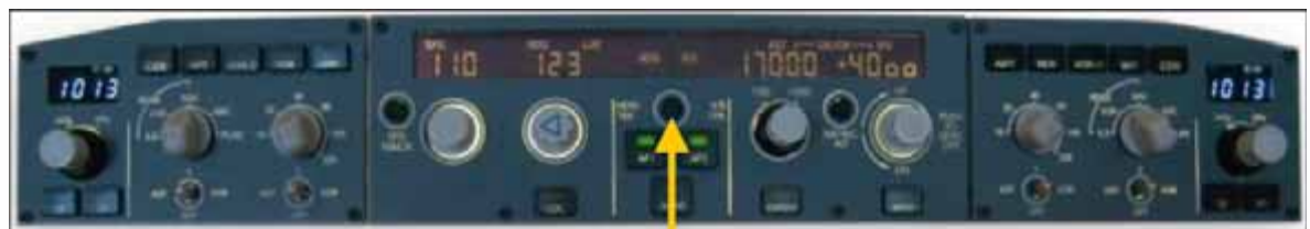
➔ Abb. 5: FCU A320: Mit dem schwarzen Knopf in der Mitte über den beiden grün leuchtenden Autopilotanzeigen kann im darüber liegenden display zwischen HDG-V/S und TRK-FPA umgeschaltet werden.
