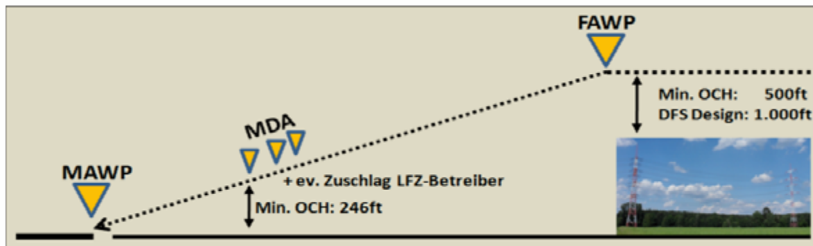
→ Abb. 1b: Hindernisfreiheit RNAV (GPS) Nichtpräzisionsanflug ohne APV-Komponente vom Final APCH – (FAWP) zum Missed APCH Way Point (MAWP)
